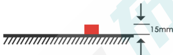
机器人越坎高度为 15mm
